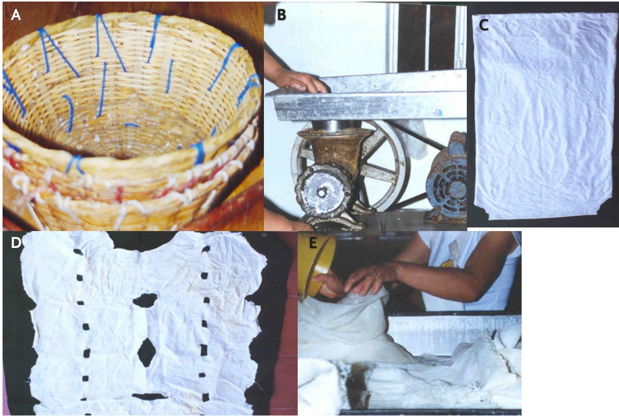
Figura 2. Equipo y superficies en queserías artesanales. A chiquigüites; B molino; C tela para filtrar leche, presenta los cortes hechos para el análisis; D tela para moldear queso Adobera, presenta los cortes hechos para el análisis; E saco de polietileno para drenar (escurrir) la cuajada.
