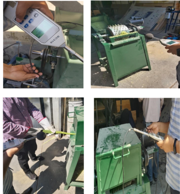
Figura 3. Ilustraciones de toma de lecturas de vibraciones y ruido.
