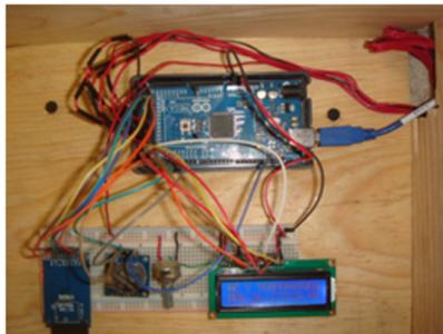
Figura 4. Sistema integrado para la adquisición de datos de los sensores.
